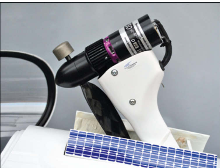
Das ATF 25 beim Ausfahren. Alles wird durch einen Schalter bedient und ist elektronisch gesteuert und gesichert
