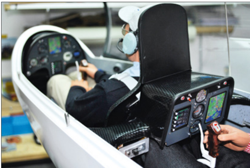
Die Cockpitteile können durch eingeklebte Magnete schnell heraus genommen werden, um die Akkus zu wechseln
