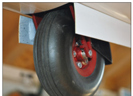
Hier gut zu sehen das rot eloxierte Aluminium und die Bremse, die durch ein Servo in der Schwinge bedient wird
