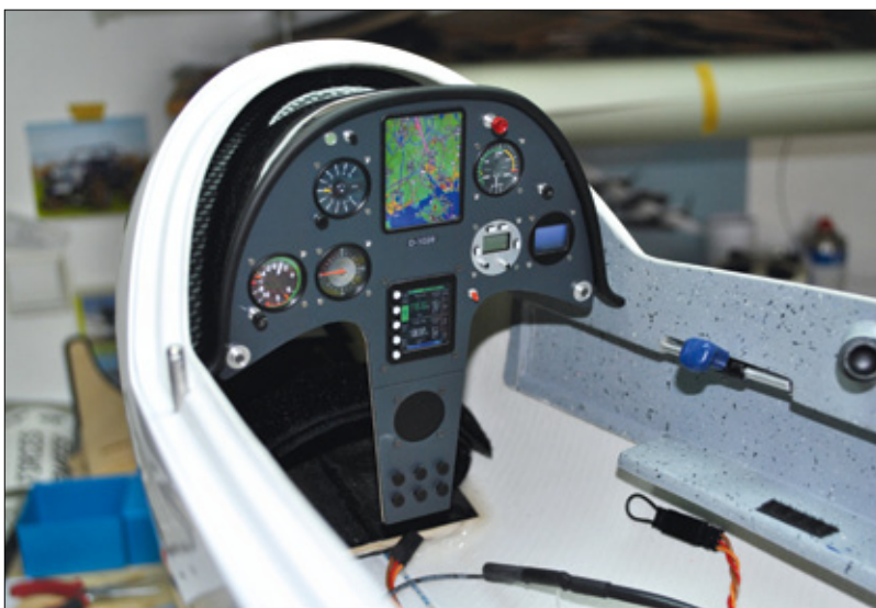
Das Panel wird ebenso durch Magnete fixiert. Die Seitenwände verbleiben im Modell
