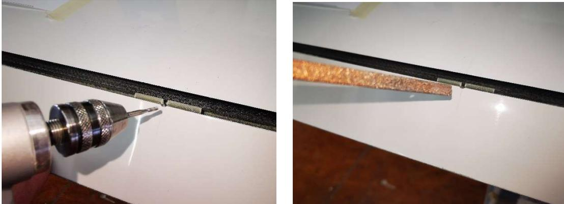
6. Gestänge testen: Die Achsdrähte müssen sauber entgratet sein (immer prüfen). Mit etwas Schmierfett die Achse und das Schubstangen-Bohrungen leicht fetten. Dann testhalber die Achsen in den Servohebel und in Schubstangen-Bohrungen stecken.
